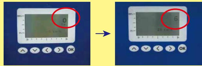
ヒートキップ施工時の蒸気流量の変化を確認。
